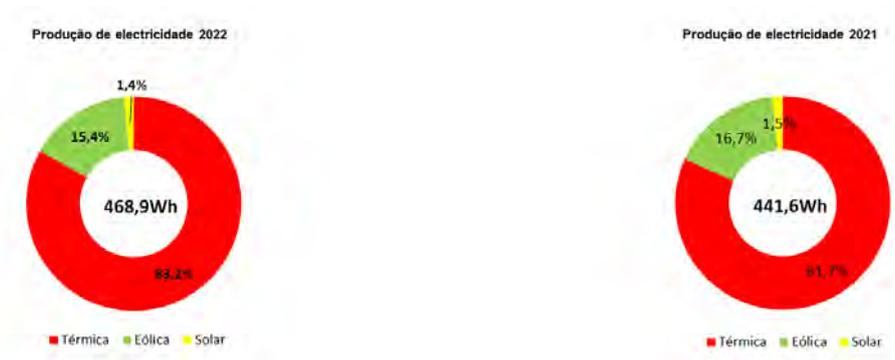
Diagrama anual de produção de energia elétrica por fontes primárias (MWh)
