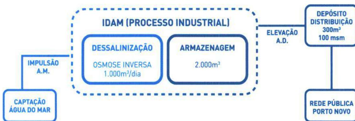
Os processos de captação de água do mar, elevação à IDAM, alimentação às unidades dessalinizadoras, dessalinização por osmose inversa, post-tratamento, armazenagem e elevação à rede pública são monitorizados por sistema de telecontrolo personalizado, mediante o programa informático SCADA.
