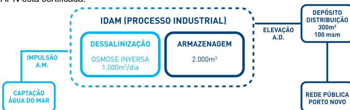
Os processos de captação de água do mar, elevação à IDAM, alimentação às unidades dessalinizadoras, dessalinização por osmose inversa, post-tratamento, armazenagem e elevação à rede pública são monitorizados por sistema de telecontrolo personalizado, mediante o programa informático SCADA.
